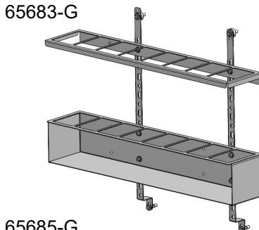
ATTACH APPROPRIATE TRAYS TO THE RAILS AS SHOWN USING THE ABOVE LISTED FASTENER. ENSURE THAT THE ASSEMBLY IS SQUARE BEFORE TIGHTENING FASTENERS.
